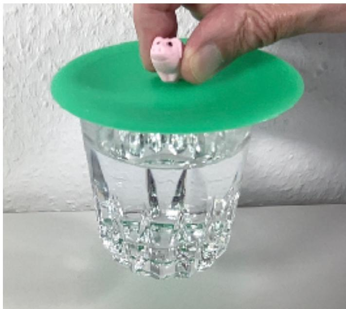
**Abb. 2: Das Saugnapf - Prinzip:** Der geschlossene Saugnapf hält das Gewicht
